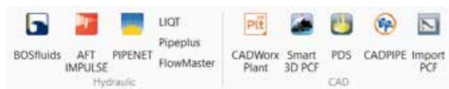
CAESAR II 与三维设计软件具有双向接口，用户可以快速地从三维软件中导入模型，消除手工输入错误。其中与 CAD 软件接口包括：Intergraph Smart® 3D、CADWorx、PDS、CADPIPE 和 PCF；水力学软件 接 口 包 括：AFT、PIPENET、LIQT、Pipeplus、FlowMaster；文本文件接口：众多的第三方软件；CAESAR II 可访问的数据库文件包括：Smart 3D、Lisega（管道支吊架设计）等。
